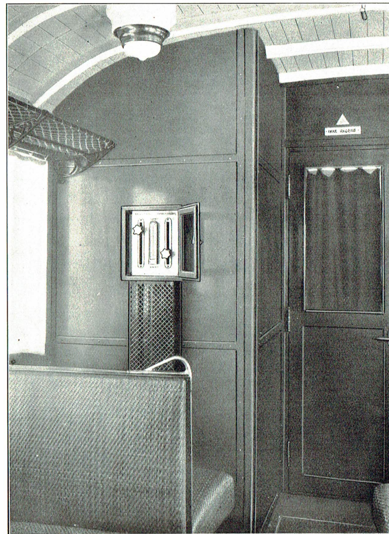
Fig. 10. Reguleringsskab for dobbelt Regulering (Dampslange og Fyr)
