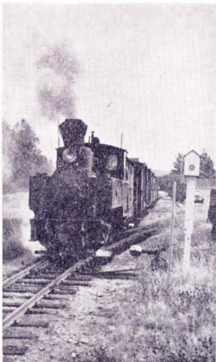
Bemærk »stærekassen«, der er stationens hovedsignal, her anbringes i mørke en lygte med rødt eller grønt lys.
