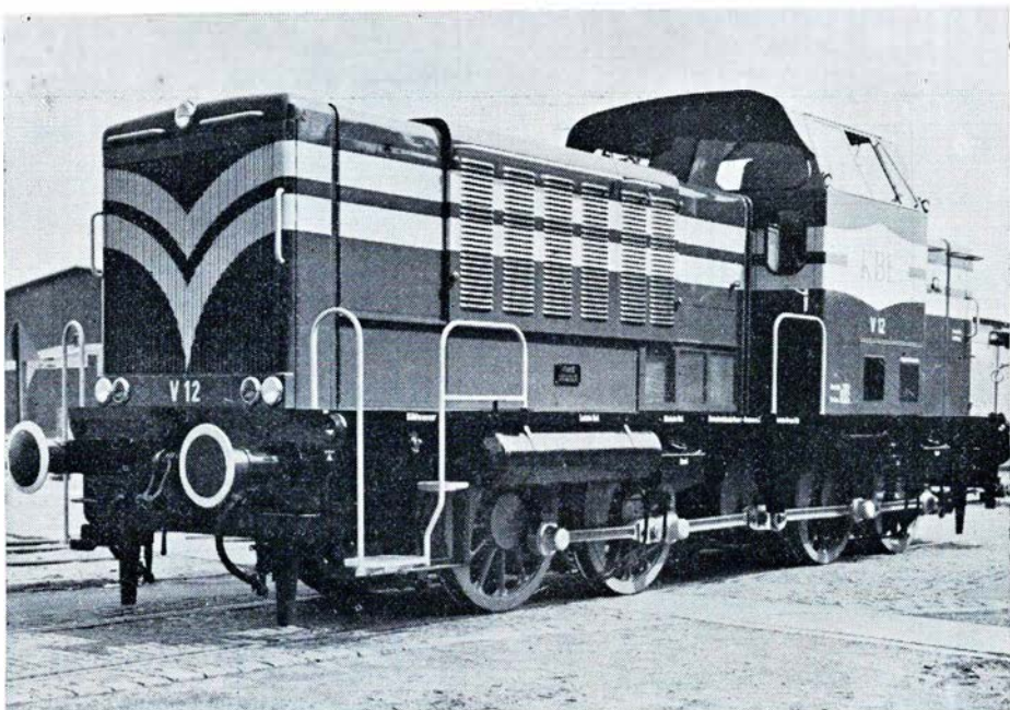
Fig. 6. MaK lokomotiv 650-800 hk. Denne type er i drift på Frederiksværkbanen, Lollands-banen, Gribskov-banen og Hjørring-banen.
