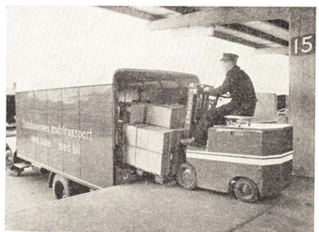
Fig. 4. Atlæsning fra lastbil ved hjælp af gaffeltruck
