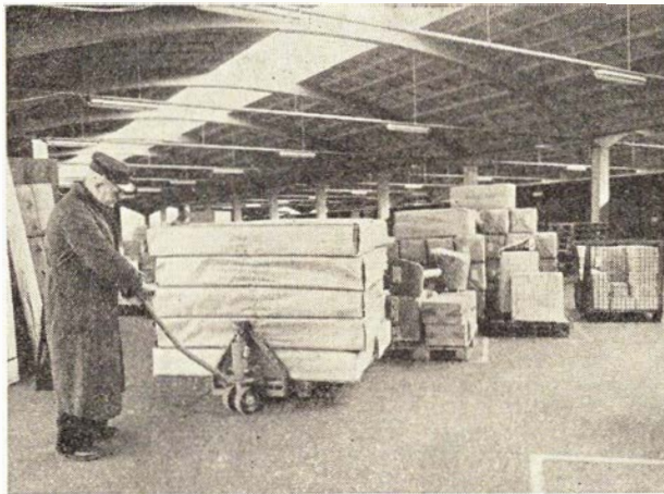
Fig. 5. Læsset lastpalle udleveres ved hjælp af løftevogn.
