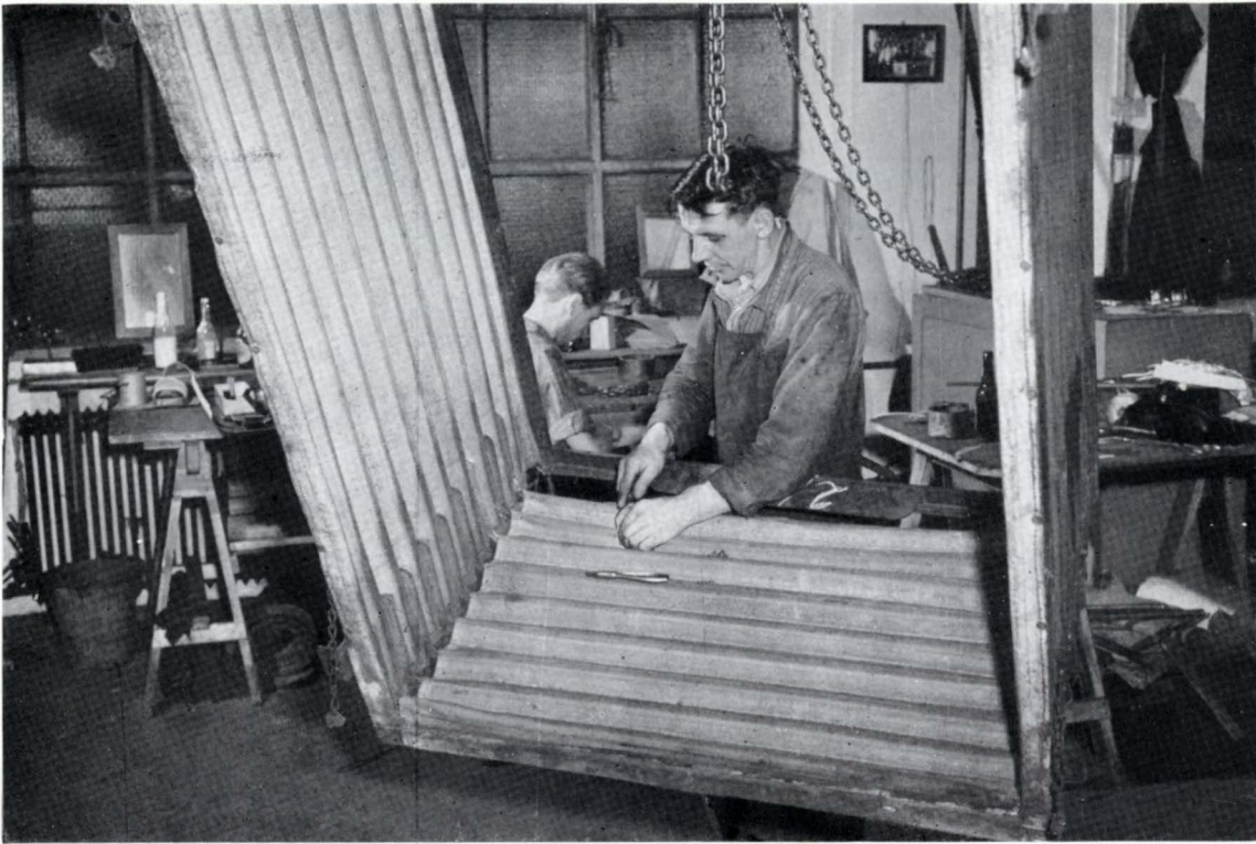
I centralværkstedernes sadelmagerværksted repareres bl. a. »harmonikaer« (forbindelsesled mellem personvogne).
