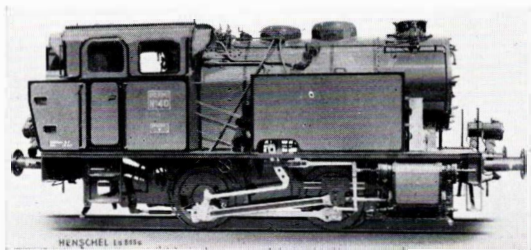
Bild 243. Naßdampf-Zwilling-Tenderlokomotive gedrängter Bauart für Industriebahnen
