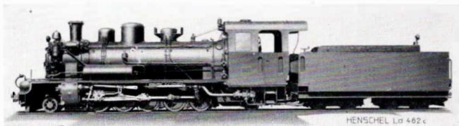
Bild 225. Heißdampf-Zwilling-Güterzuglokomotive für Kleinbahnen
