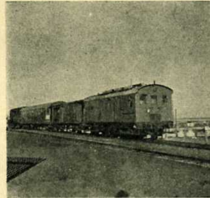
Gennemsnitstog af 1959. Personvognen er en 4-akslet truckvogn bygget af Scandia efter krigen (89 siddepl.)
